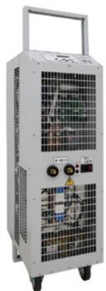
Система контролируемого разряда (СКР) предназначена для проведения контролируемого разряда аккумуляторной батареи (АБ) в режимах «с постоянным током» либо «с постоянной мощностью». СКР может изготавливаться в виде как стационарного (шкафного), так и переносного устройства с питанием от однофазной сети переменного тока (220 В, 50Гц) и имеет исполнения на токи от 50 до 200А.
